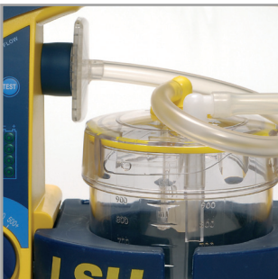
Conectores identificables por códigos de color y de tamaño
